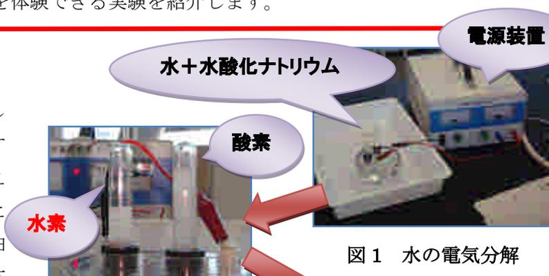
図1 水の電気分解
