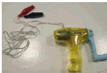
図1 手回し発電機 手回し発電機同士をつなげることでモーターとしても使用することができる。
