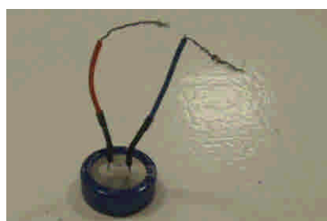
図3 コンデンサー 電気を電気のまま充電できる。ショートさせることで放電できる。
