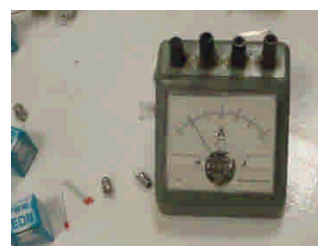
図4 電流計 直列にコンデンサー、電球、電流計をつなぐ。
