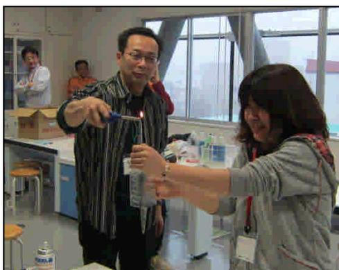
図4 火をつけるとガラス管の先が赤くなります。水素が燃えています。
